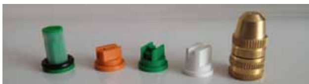
Postřikovače jsou vybaveny sadou štěrbinových a kuželových trysek.
